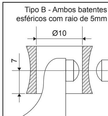
**Exemplo de medição com o micrômetro com ambos batentes esféricos:** Esta configuração é ideal para medição de espessura ou parede de peças cilíndricas quando as superfícies interna e externa são curvas.
