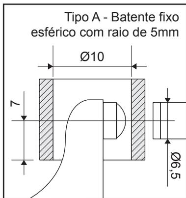
**Exemplo de medição com o micrômetro com um batente plano e um batente esférico:** Esta configuração é ideal para medição de espessura de peças cilíndricas, como paredes de tubos por exemplo.
