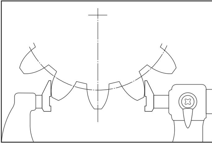
**Exemplo de medição da largura dos dentes de engrenagens:** Este tipo de micrômetro é utilizado para a medição da largura entre 3 dentes da engrenagem, ou comprimento da base tangente, ou ainda medição  $W$ .
