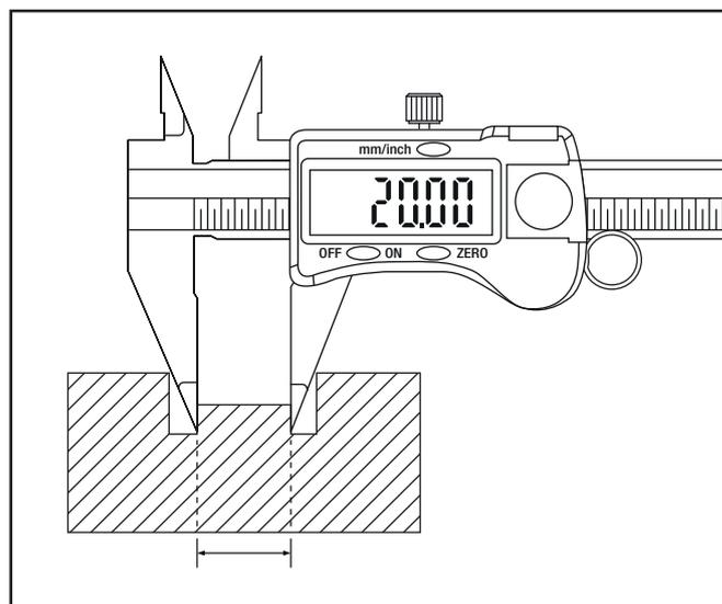
**1) Medição externa:** Nas medições de peças comuns sempre mantenha a maior área de contato possível nas faces de medição externas. Evite utilizar somente a extremidade dos bicos.
