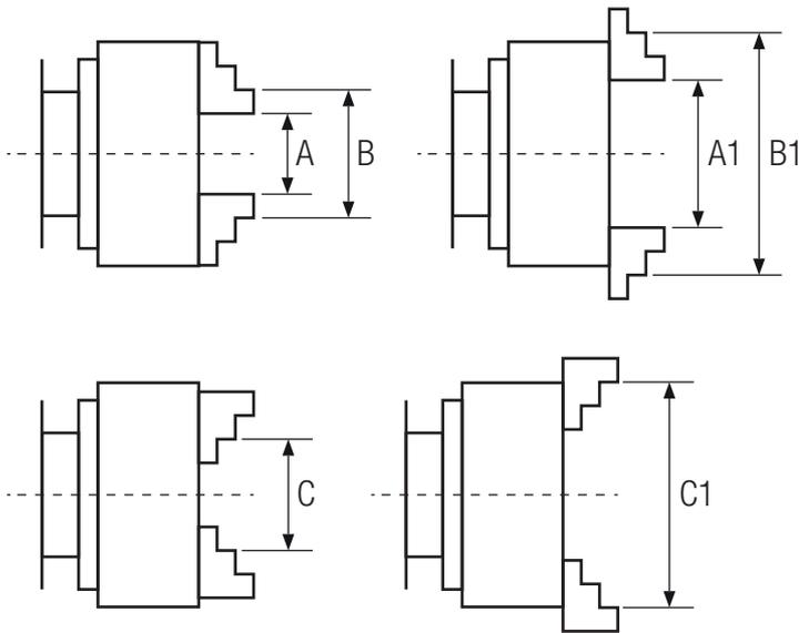
Capacidade de fixação das placas (em milímetros - mm):
